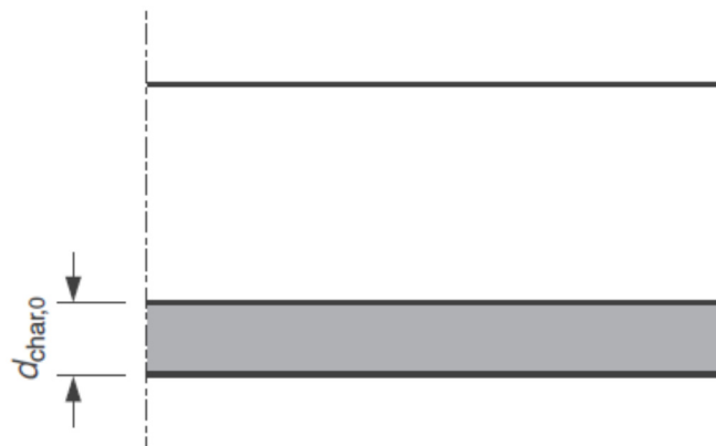
Kuva 1. Tasomaisen rakenteen yksidimensioinen hiiltyminen, kun palorasitus on ainoastaan rakenteen toisella puolella. (Lähde: EN 1995-1-2).
